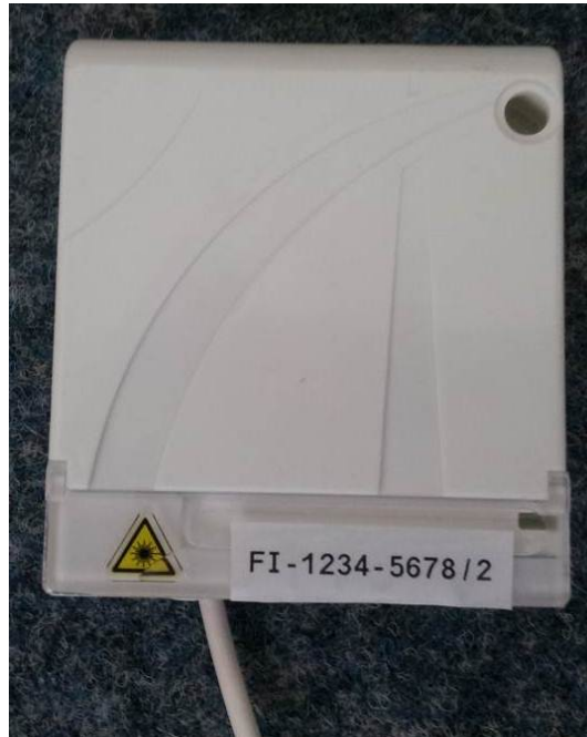
Figure 3 : repérage de la PTO déportée
