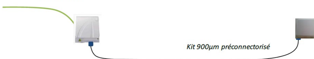
Figure 4 : exemple de câblage avec PTO déportée
